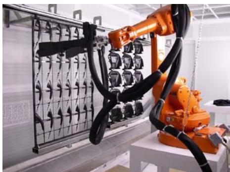
Čištění plastových dílů před lakováním aplikací Cryosnow za pomoci robota
