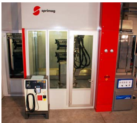
Tryskácká kabina (Cryosnow) zakomponovaná do automatické lakovací linky
