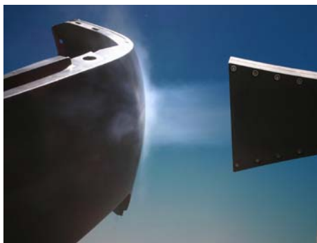
Čištění plastových nárazníků před lakováním aplikací Cryosnow
