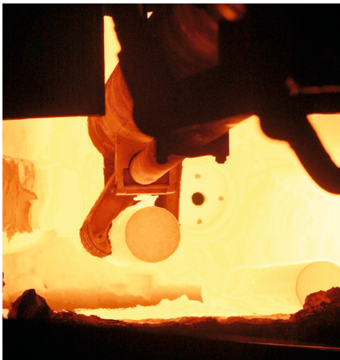
Vyjmutí ohřátého materiálu z pece, která využívá technologii REBOX®
